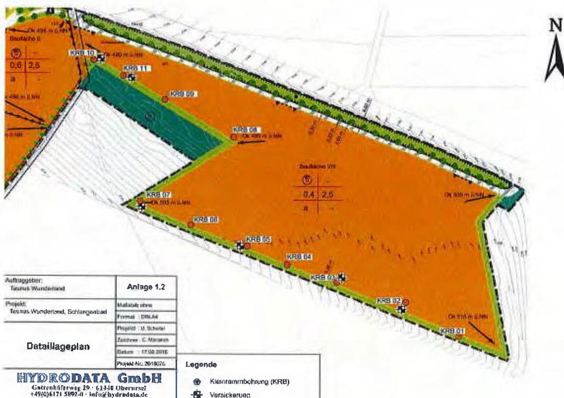
**Abbildung 2:** Lageplan mit den Ansatzpunkten der Bohrungen [U 4]
